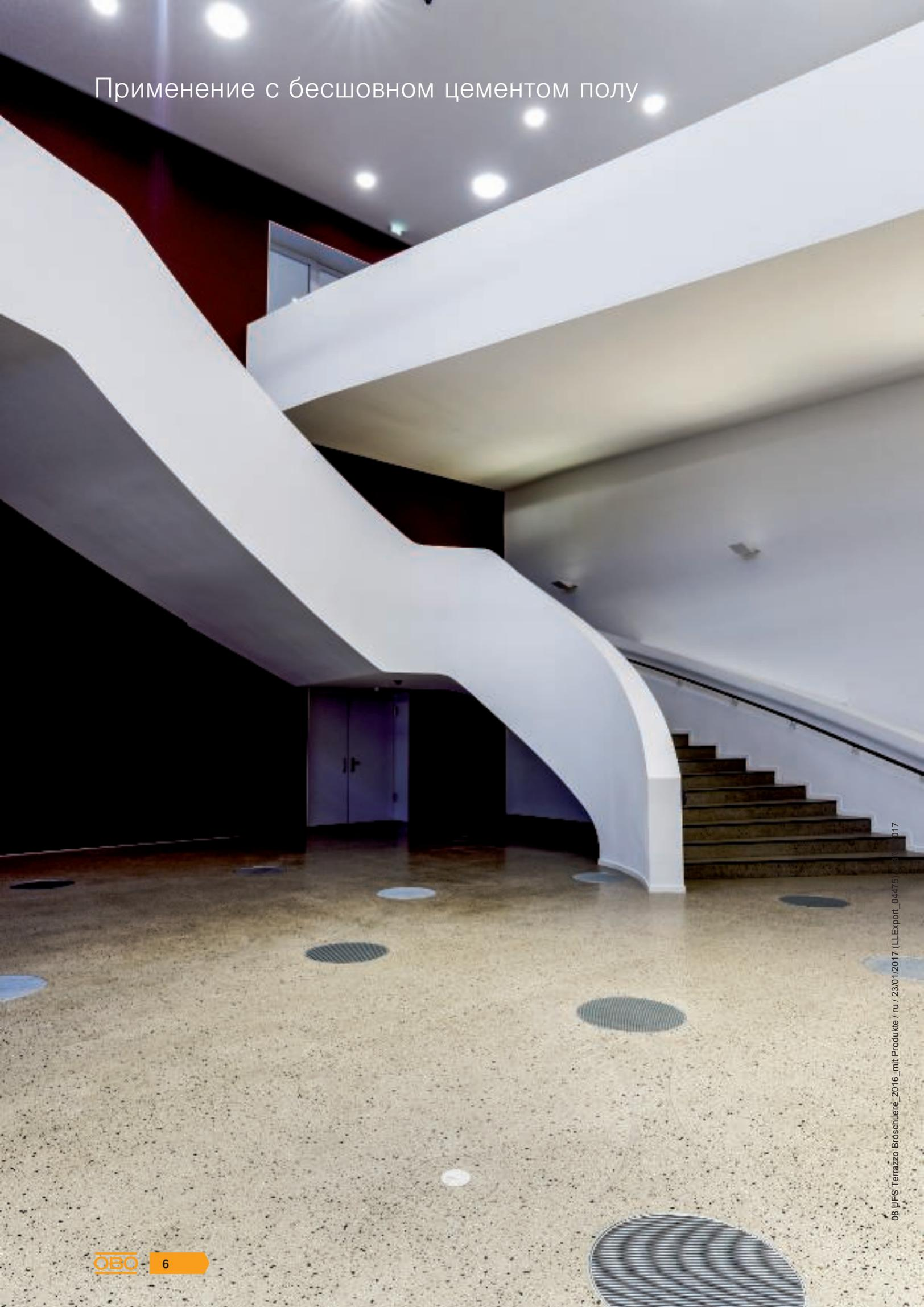
Системное решение ОБО Беттерманн для бетонного полированного пола может применяться и в бесшовной цементной стяжке. После многократной шлифовки цементного покрытия образуется ровный бесшовный пол зернистой структуры. Один из вариантов такого покрытия - мозаичный пол или терраццо. Терраццо состоит из двух слоев - несущего и декоративного. По желанию архитектора или дизайнера, в декоративный слой для его оформления можно добавить цветные или каменные вкрапления.
