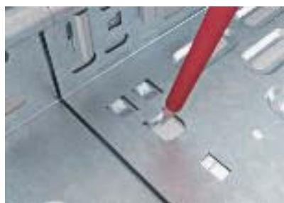
Стыковое соединение без винтов, требуется только загиб накладок основания
