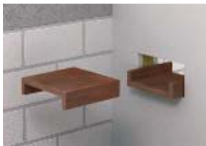
Ввод разделенной рамки в легкие перегородки
