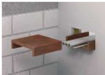
Монтаж рамки для уже проложенных кабелей
