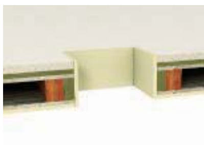
Перекрытие на деревянных балках
